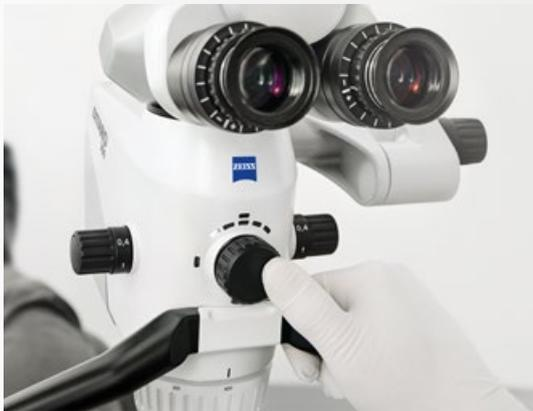
*Activación de los modos de visualización y de captura y los ajustes de luz*
